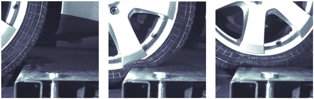
Imagem 3: Reprodução de um curb test, mostrando a forma como o pneu se deforma ao atingir um obstáculo.
